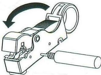
4. Nehmen Sie das Kabel heraus und entfernen Sie den Außenmantel sowie das Dielektrikum, um die Leiter frei zu legen. Achten Sie auf etwaige Kurzschlüsse.
